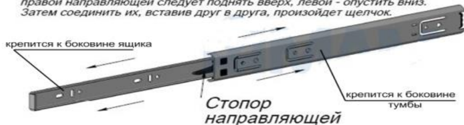
Рис.2 Схема установки шариковых направляющих
