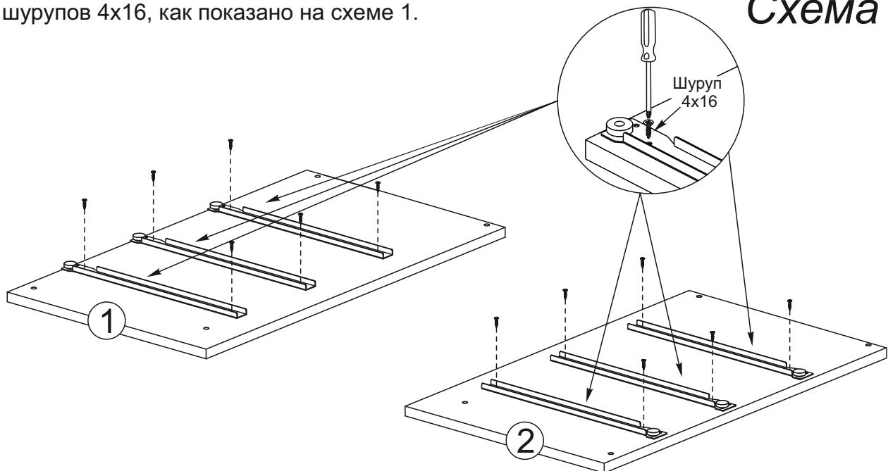
3. Соедините евровинтами боковины №1 и №2 с цоколями №4, планками №5. Закрепите крышку №3. Для этого вверните шурупы 4x25 в крышку №3 через планки №5, как показано на схеме 2.
