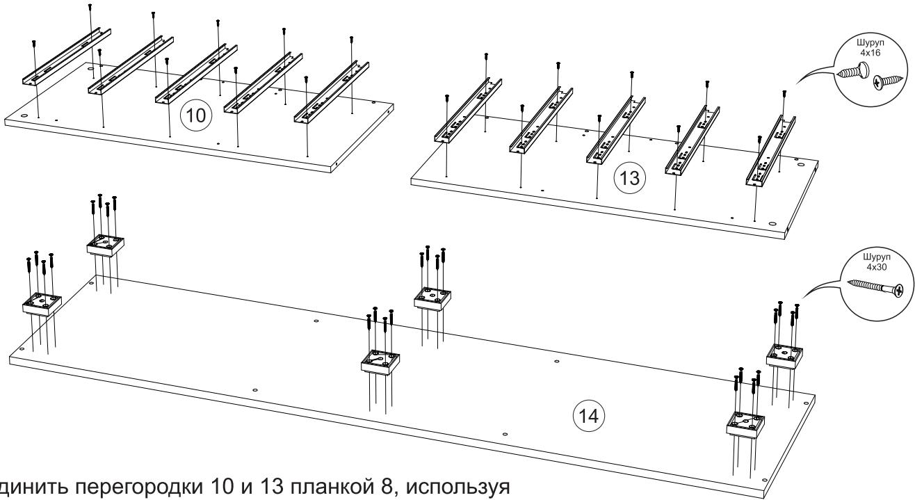
**3)** Соединить перегородки 10 и 13 планкой 8, используя эксцентриковые стяжки. Закрепить задние стенки 5 и 12 к перегородкам 10 и 13 евровинтами. Закрепить вязки 9 к перегородкам 10 и 13 эксцентриковыми стяжками.
