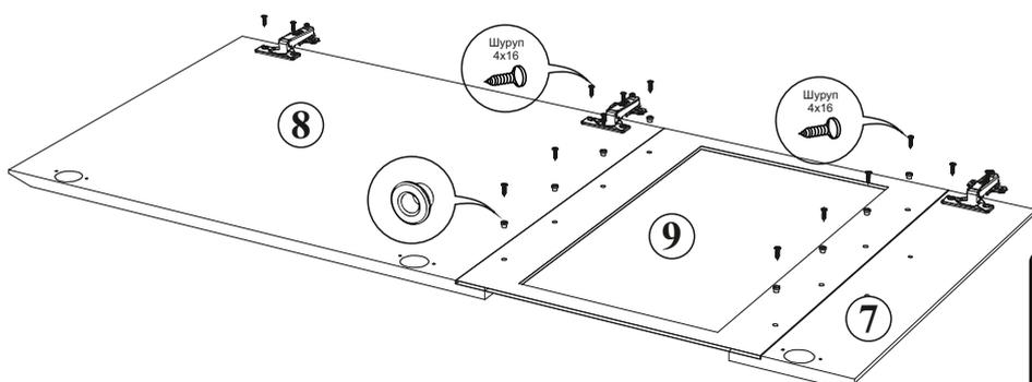
5. Положить панели 7 и 8 горизонтально, лицевой стороной вниз, затем соединить их стеклом 9, используя шурупы 4x16 и втулки для стекла. Закручивание шурупа производить медленно, без усилия, во избежание повреждения стекла.
