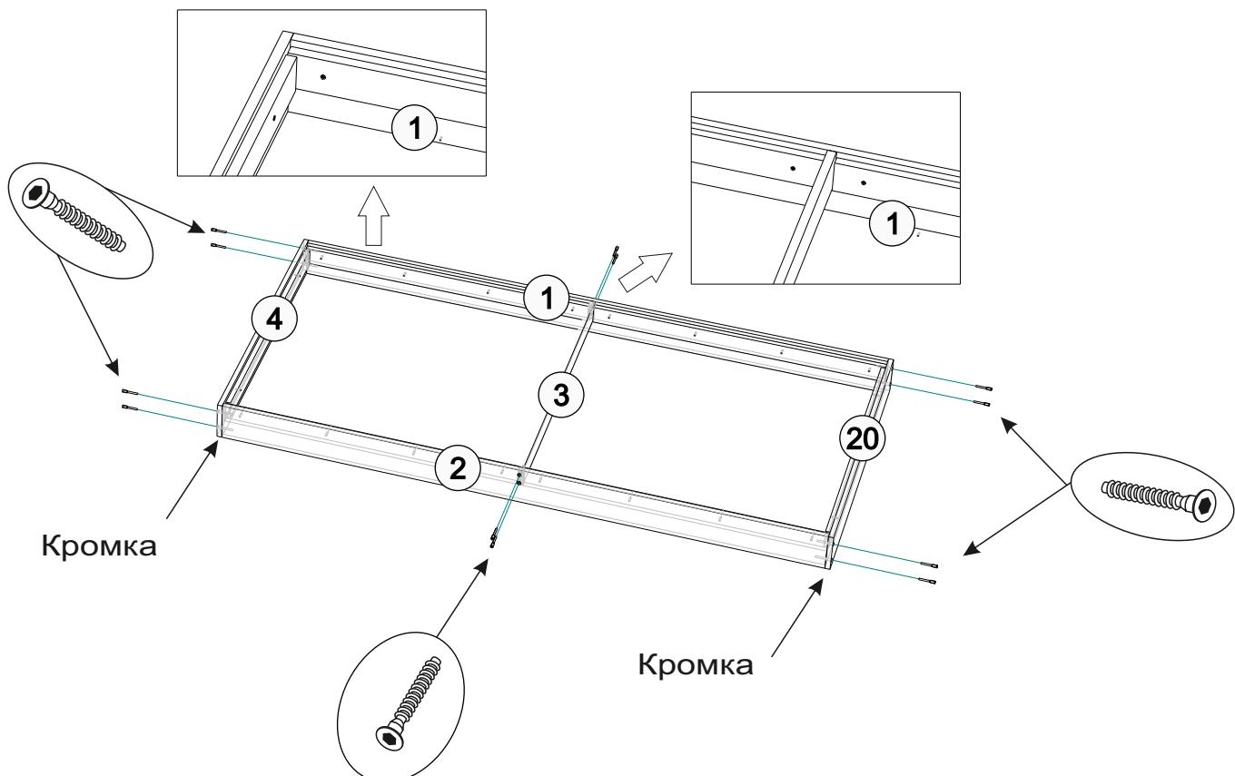
11. Измерьте диагонали А и Б собранного модуля, они должны быть равны.
