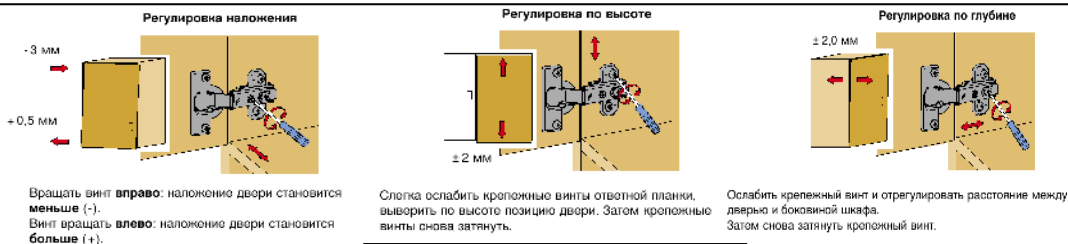
Рис. 3 Схема установки петель
