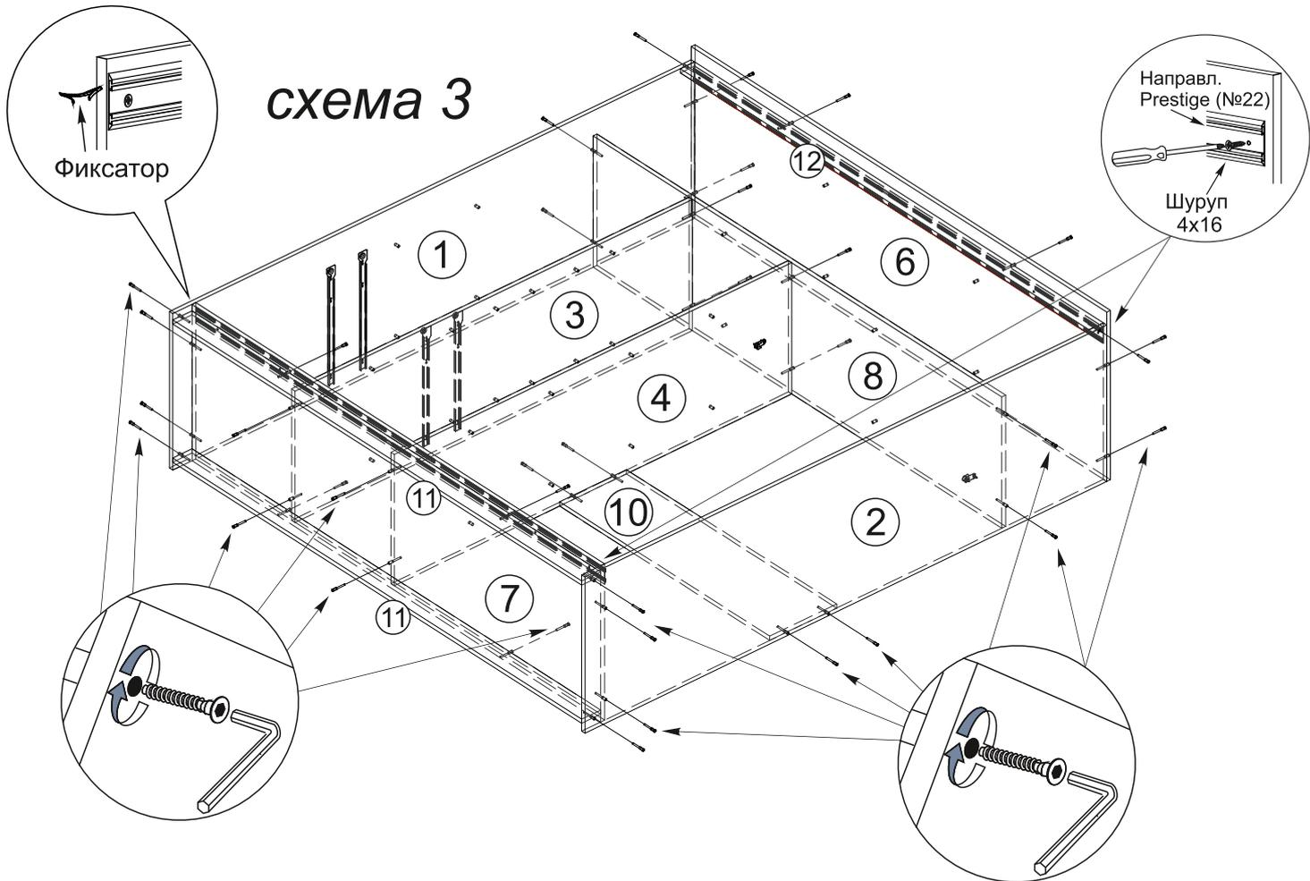
5. Чтобы установить заднюю стенку (деталь №16), необходимо собранную конструкцию перевернуть лицевой стороной вниз. Замерить, с помощью рулетки, и уровнять диагонали ( $a=b$ ). Наложить задние стенки, соединив их профилем №19, где это необходимо. Аккуратно, не нарушая диагоналей, прибить ЛДВП гвоздями, с шагом 130-150 мм (схема 4).
