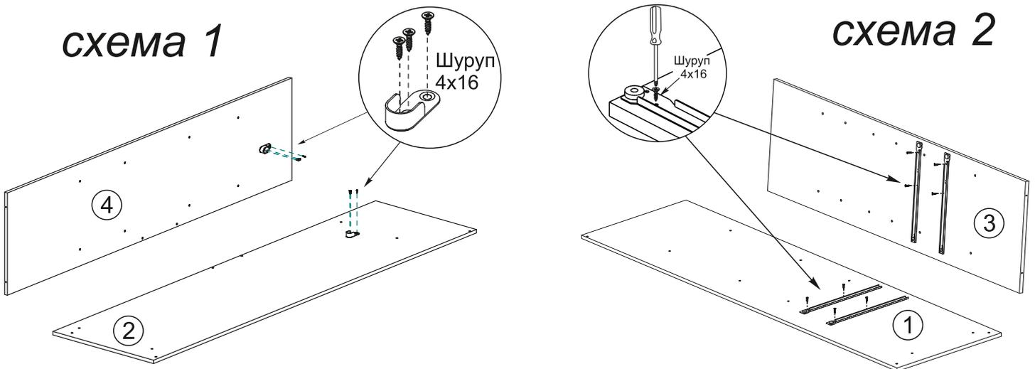
3. Присоедините к вязке №7 с помощью евровинтов цоколя №11. При помощи шурупов 4x16 закрепите на крышке №6 и вязке №7 направляющие Prestige согласно наметкам, установите в направляющую на вязке №7 фиксаторы (по одному на дверь, см. схему 3). Присоедините к вязке №7, с помощью евровинтов, боковины №1 и №4, перегородки №2 и №3.
